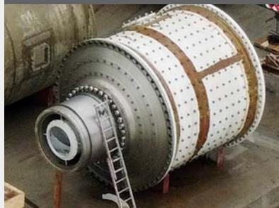
Die Zementmühle ist als Zweikammer-Kugelmühle ausgeführt und dient der Vermahlung der Grundkomponenten wie beispielsweise Zementklinker, Kalkstein und Gips, aus denen Zemente hergestellt werden. Im Inneren der Mühle werden harte und schwere Stahlkugeln durch die Trommel bewegt, wodurch Schlag- und Reibwirkungen auf das Mahlgut entstehen. Das führt zur Zerkleinerung der Komponenten auf die für den jeweiligen Zement vorgegebene Feinheit. |
